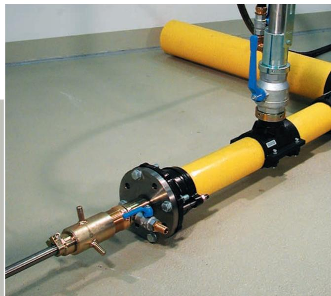
Abb. 5: Anbohrung über AQUAFAST®-Klemmflansch und Blasenetzgerät/FRIALEN® SPA
