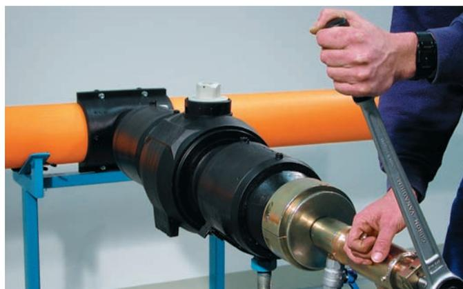
Abb. 4: Anbohrung über Spannaufnahme und Kugelhahn
