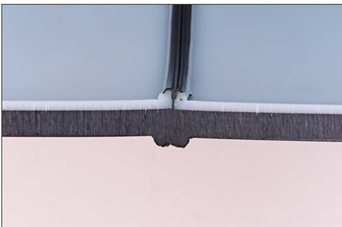
Bild 3: Schnittbild durch eine Stumpfschweißnaht
