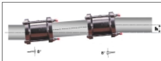
Bild 2: Einbau eines neuen Rohrstückes mit 2 Kupplungen
