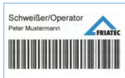
Abb. 4: Schweißcode (ISO DIS 12176-3, 30-stellig)
