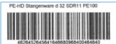
Abb. 6: Beispiel für Rückverfolgbarkeits-Barcode Rohr nach internationale Norm ISO/DIS 12176-4 für Rohre: 40-stellig (Code 128, Typ C)
