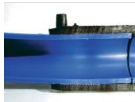
Bild 4: Detail Verbindungszone - Biegespannungen durch Ringbündelware werden in den Haltezonen aufgenommen
