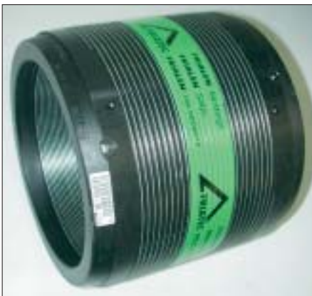
Bild 10: Fitting-Außenarmierung behindert dessen Ausdehnung während der Schweißung
