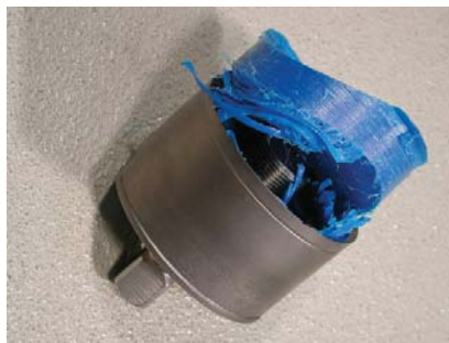
Abb. 6: Die Späne werden während des Anbohrvorgangs nahezu vollständig in der Fräserkrone zurückgehalten
