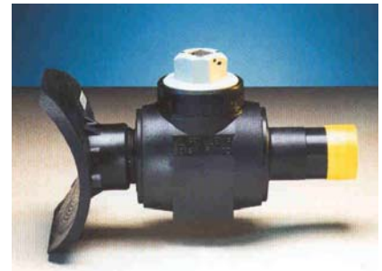
Abb. 1: Der Anbohrkugelhahn AK-HP ist ein besonders kompaktes Bauteil mit integrierter Absperrrichtung zur leakagearmen Anbohrung der Hauptleitung unter Betriebsdruck.
