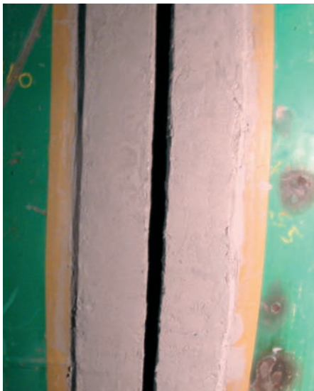
Bild 7: 2-Komponenten Ausgleichsschicht auf Stahlrohr DN 3500
