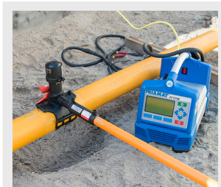
Bild 8: Typische Gas-Hausanschlussleitung mit Druckanbohrarmatur DAA, FRIASTOPP Langmuffe mit integriertem Gas-Strömungswächter und der Anschlussleitung d32, PE100/SDR11
