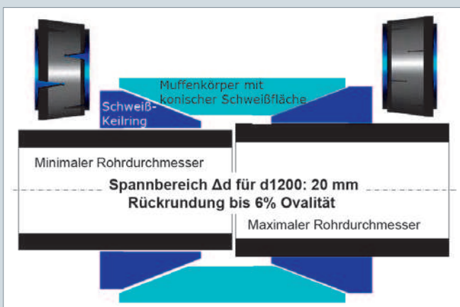
BILD 7: Montierbarkeit in Abhängigkeit des Ist-Durchmessers
