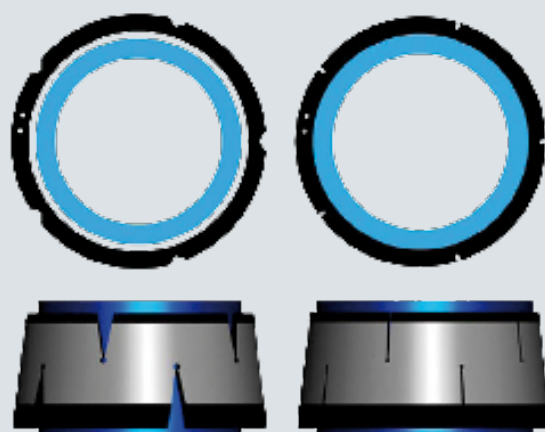
BILD 2: Wirkprinzip des Schweißkeils: Die Flexnuten lassen eine Durchmesserreduzierung zu, so dass der Fügspalt zwischen Rohr und Schweißkeil überbrückt wird
