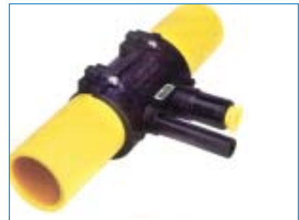
Abb. 2: FRIALEN-Druckanbohrarmatur mit parallelem Dom (DAP): Zusätzliche Sicherheit für den Hausanschlussbereich bei Baggereingriff, Kostenreduzierung durch geringere Überdeckungshöhe.
