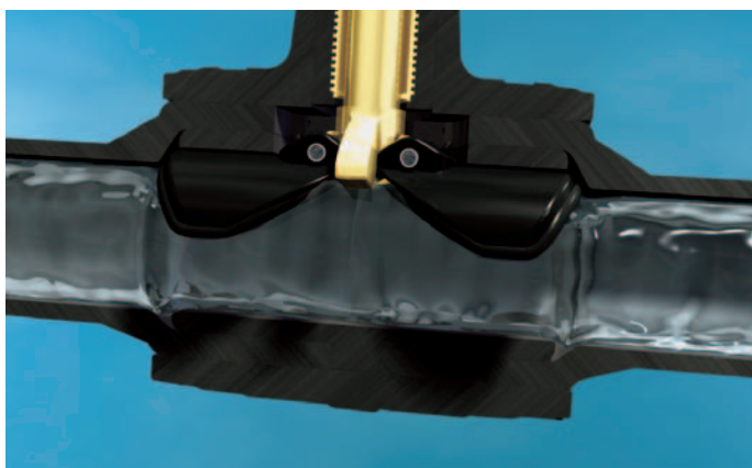
Bild 3: Absperrarmatur FRIALOC – offen: die Klappenstellung ermöglicht nennweitengleichen Durchgang bei kompakter Bauweise (links); geschlossen: doppelte Absperrung mit Pufferfunktion im Klappen-Zwischenraum (rechts)
