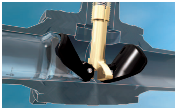
Bild 3: Absperrarmatur FRIALOC – offen: die Klappenstellung ermöglicht nennweitengleichen Durchgang bei kompakter Bauweise (links); geschlossen: doppelte Absperrung mit Pufferfunktion im Klappen-Zwischenraum (rechts)
