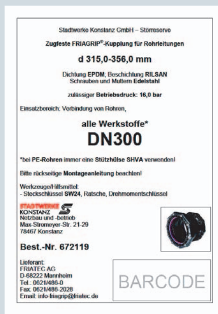
BILD 4: Beispiel einer Bauteilbeschriftung (Quelle: FRIATEC AG)
