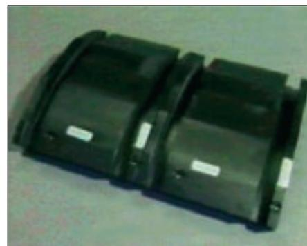
**Bild 11:** Beliebige Vergrößerung der Reparaturfläche durch Kombi-Schweißung der Schulterfläche
