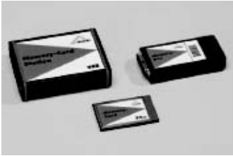
Bild 12: Datenspeicherung mittel Memory-Box, Memory-Card (PCMCIA) oder Memory Stick (USB)
