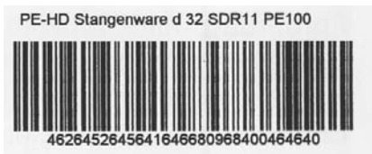
Bild 8: Beispiel für Rückverfolgbarkeits-Barcode Rohr
