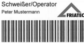
Bild 4: Schweißcode (ISO DIS 12176-3, 30-stellig)
