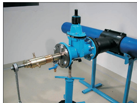
Bild 7: Einbindung einer Abzweigleitung über Flanschschieber. Die Befestigung des Anbohrgeräts erfolgt ebenfalls über den Flanschabgang
