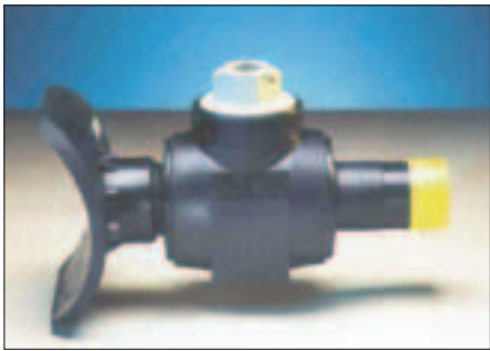
Bild 9: Anbohrkugelhahn Top-Loading: Kombination von Sattelformstück und Absperrarmatur für Rohre bis d 560 mm
